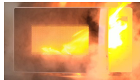
電子レンジ（庫内）火災の再現映像
