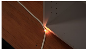
電源コード（半断線）火災の再現映像
