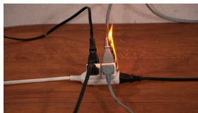
テーブルタップ・プラグ トラッキング現象の再現映像
